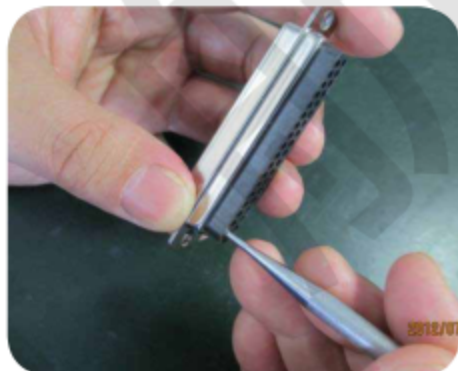
接触件拆卸示意图
